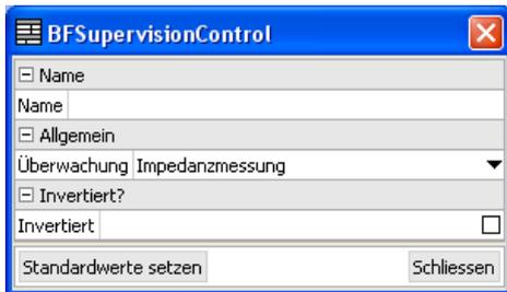
Die Funktion gilt nur für die zugehörige Steuereinheit. Hier kann gewählt werden, welche Überwachung gesteuert werden soll. Die Funktion kann invertiert werden. (Standard: offen / geschlossen)
