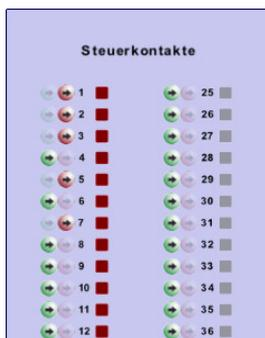
Das VCM wird direkt mit einem UIM im Design-Modus verbunden (siehe Kapitel Hardwarekonfiguration). Dadurch werden 12 Steuerkontakte am UIM belegt und stehen nicht mehr für andere Funktionen zur Verfügung.
