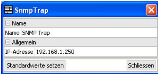
In den Eigenschaften des Objektes kann die IP-Adresse des SNMP-Clients angegeben werden. Das Objekt selbst wird mit jener Steuereinheit verbunden, die diesem SNMP-Client, Traps schicken sollen.
