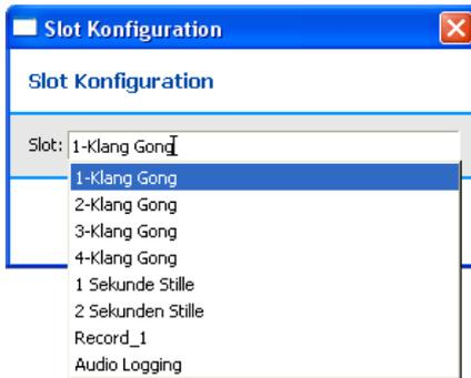
Über den Button >Bearbeiten< sowie Doppelklick auf die Verbindungslinie einer Durchschaltung wird ein Fenster geöffnet, über das man den gewünschten Slot auswählen kann. Hier werden alle Abspiel- bzw. Aufnahmeslots angezeigt.
