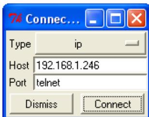
Host ist die IP-Adresse der Steuereinheit, zu dem eine Verbindung hergestellt werden soll. (Default IP ist 192.168.1.246)
