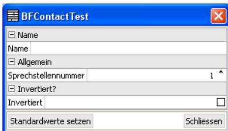
Die Funktion gilt nur für die zugehörige Steuereinheit. Hier kann gewählt werden, welcher DAL-Bus (Sprechstellennummer) getestet werden soll. Die Funktion kann invertiert werden. (Standard: offen / geschlossen)
