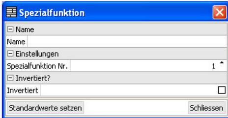
Die hier angegebene Nummer entspricht der internen Funktion der Steuereinheit, die aktiviert bzw. ausgegeben werden soll. Die Funktion kann auch invertiert werden. (Standard offen / geschlossen)
